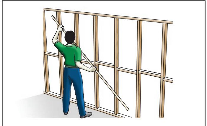
FIGURE 1 FRAME STRAIGHTNESS
